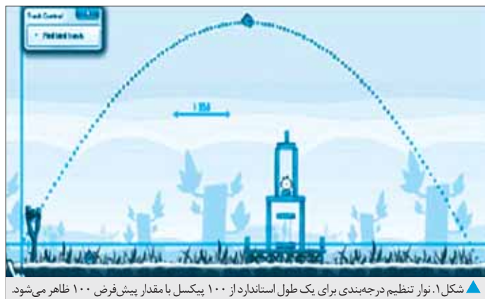
شکل ۱. نوار تنظیم درجه بندی برای یک طول استاندارد از ۱۰۰ پیکسل با مقدار پیش فرض ۱۰۰ ظاهر می شود.
